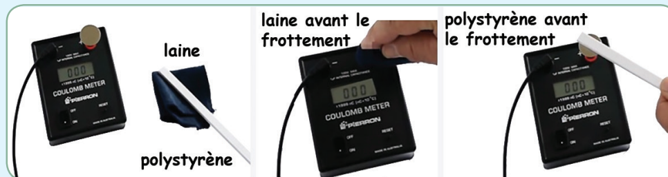
b. Charges électriques portées par la laine et par le Polystyrène avant le frottement.
