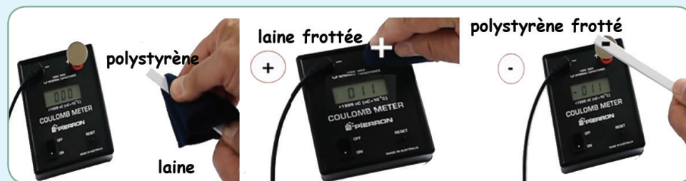
c. Charges électriques portées par la laine et par le Polystyrène après le frottement.
