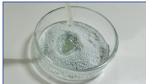
Doc.10 Huile au contact avec le sulfate de cuivre anhydre.
